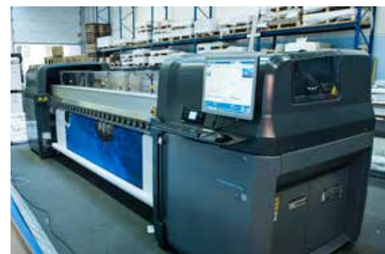
HP LX 850: Vorbereitung ... ...und Druck auf einem Bannermaterial in 3,20 m Breite
